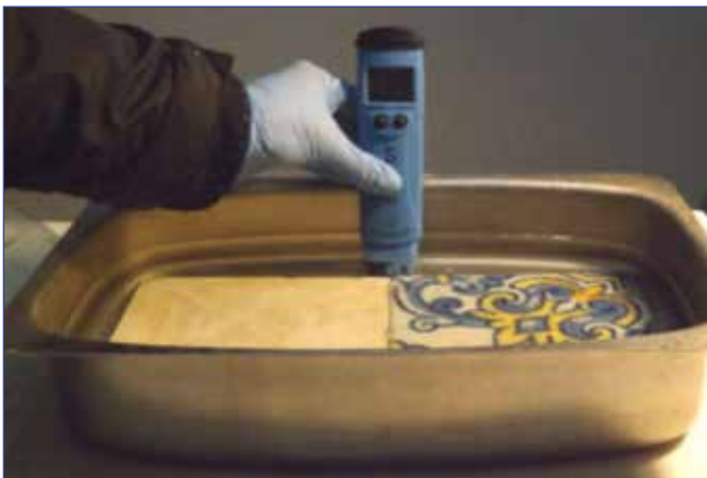
Dessalinização por imersão – medição dos valores de condutividade
