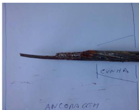
Figura 6. Pormenor da ponta do cordão que rompeu e esquema da ancoragem inferior
