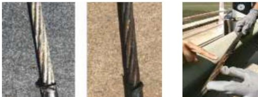
Figura 13. Amostra de cordões removidos do tirante 3-29-S
