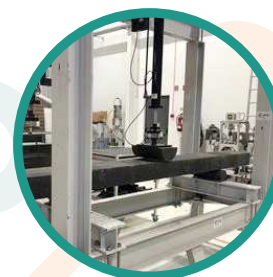
TESTE INICIAL AO PROTÓTIPO DE TRAVESSA PARA A INFRAESTRUTURA FERROVIÁRIA EM PLÁSTICO.
