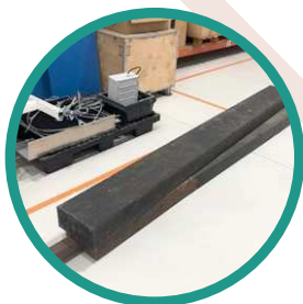
PROTÓTIPO DE TRAVESSA PARA A INFRAESTRUTURA FERROVIÁRIA EM PLÁSTICO.
