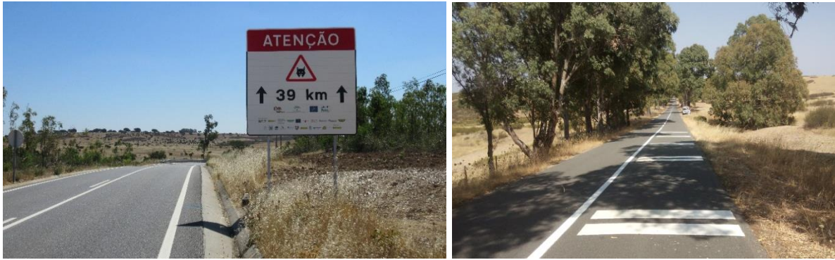
Fig. 26 – Sinalização avisadora de perigo, específica do lince-ibérico (esquerda) e bandas cromáticas redutoras de velocidade (direita) instaladas na EN122.
