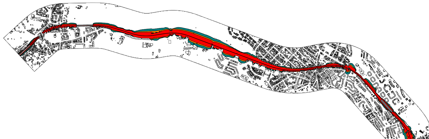
Mapa de Conflitos baseado nos MER da Linha de Sintra (Rio de Mouro/Mercês - Sintra) e na classificação acústica territorial - Indicador L_{den}
